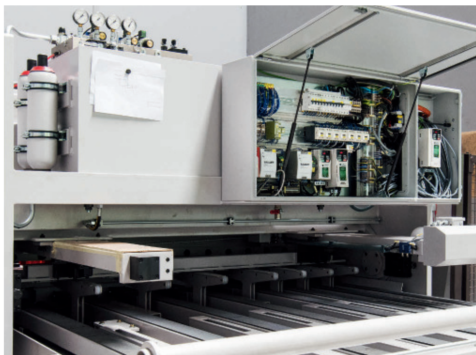
Auf der Rückseite der Schwingschnitt-Tafelschere findet sich der Schaltschrank mit der neuen «S-Dias»- und «S-Dias-Safety»-Steuerung von Sigmatek. Foto: Holger Jacob
