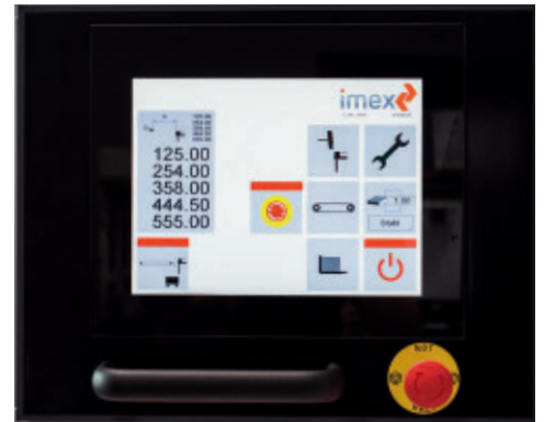
Als moderne Mensch-Maschine-Schnittstelle ist ein projektiv-kapazitives ETT Multitouchpanel in Schutzart IP65 von Sigmatek im Einsatz. Foto: Holger Jacob
